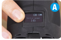
COMPTEUR DU NOMBRE DE SERTISSAGES RÉALISÉS
