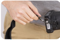
CONTADOR DEL NÚMERO DE CRIMPADOS REALIZADOS
