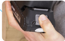
BOUTON D'ÉJECTION DE LA BATTERIE
