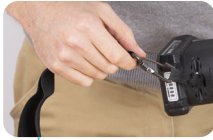
COMPTEUR DU NOMBRE DE SERTISSAGES RÉALISÉS
