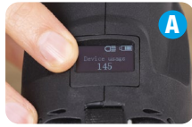
CONTADOR DEL NÚMERO DE CRIMPADOS REALIZADOS
