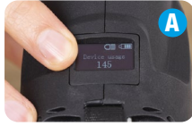
TELLER VOOR HET AANTAL UITGEVOERDE PERSBEURTEN
